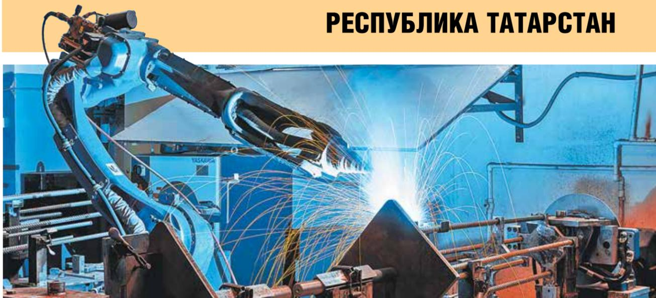
Сварочный робот для производства металлоконструкций
