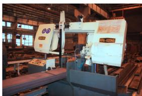
Резка листового проката, в том числе, под углом и снятие фасок круглого, шестигранного, квадратного, труб, уголков, швеллеров, двутавров, полосы из листа толщиной от 1мм до 300 мм длиной от 10мм до 120000 мм на оборудовании плазменной резки и термической резки **SEKATOR**, лентопильных **Delta HFA – 620NS, CARIF 260, KASTOcut GU4**, пресс ножницах **Geka HYDRACROP 80/150S**, отрезная дисковая машина **Корвет - 430** и гильотинные машины **H3221 и H0 3314Г**.
