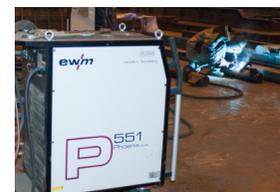
Способы сварки - полуавтоматическая сварка в среде защитных газов, ручная электродуговая сварка штучными электродами, ручная аргодуговая сварка. Максимальная масса свариваемых металлоконструкций – 30 т. Максимальные габариты собираемых металлоконструкций при размещении на плитах или технологических балках под сборку-сварку :
