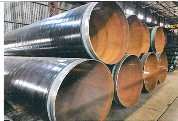
Фото 1: Общий вид труб повторного применения в изоляции
