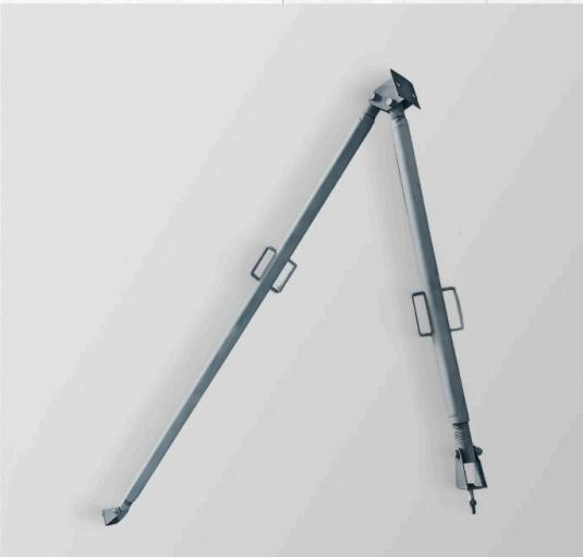
Двухуровневый подкос в опалубке – это металлическое приспособление, используемое для фиксации и поддержания опалубочных щитов в вертикальном положении при бетонировании
